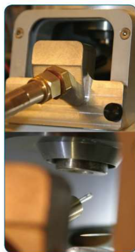
図1: 分析用サンプルを支持するASAP プローブとガラスキャピラリーの写真
